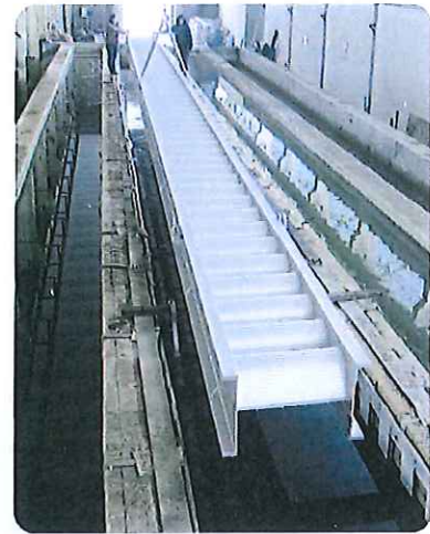
30m 铝合金阳极氧化槽 30m Aluminum alloy anodic oxidation vat
